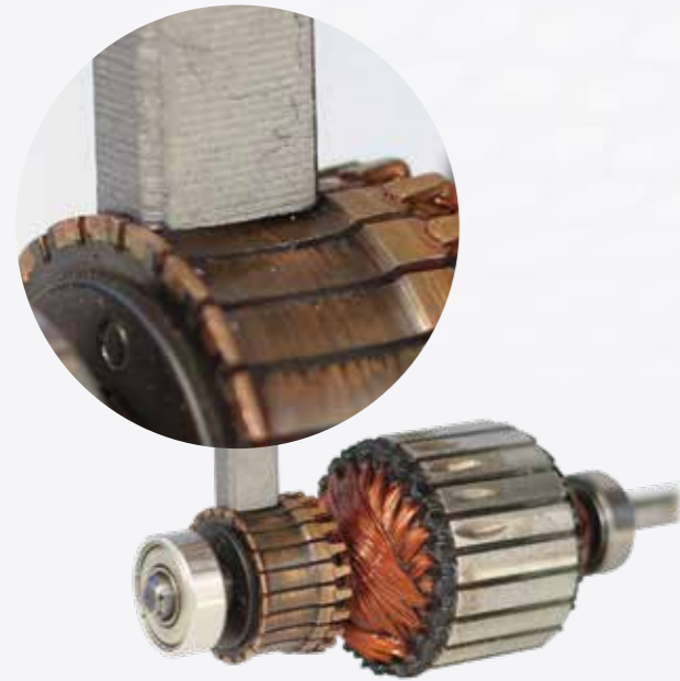
Moteur après 1 000 heures de fonctionnement et une commande conventionnelle
